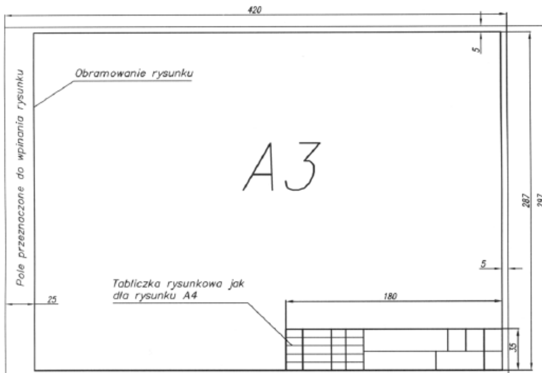
Rys. 12. Wymiary arkusza rysunkowego formatu A3 oraz usytuowanie tabliczki rysunkowej.
